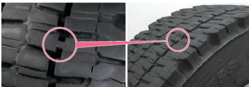
プラットホームが露出した例
