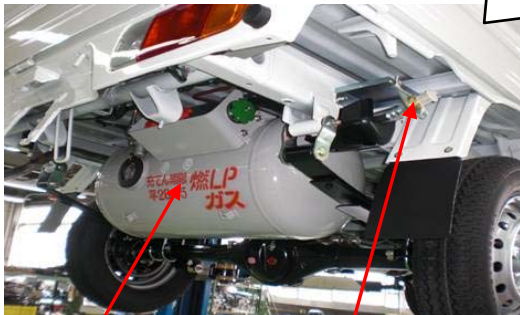
燃料ガスタンク
