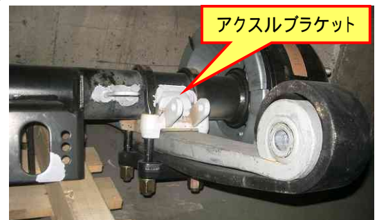
取り付け位置を誤った部品(アクスルブラケット) (写真は正規品)
