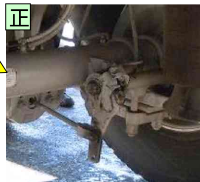
取り付け位置を誤った部品(アクスルブラケット) (写真は正規品)
