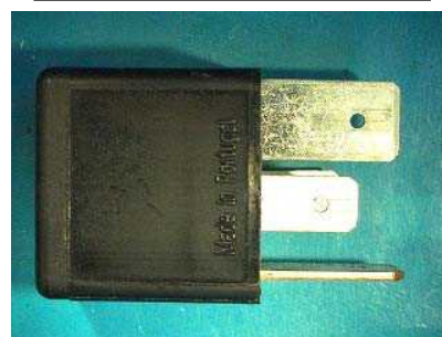
2次エアポンプリレー
