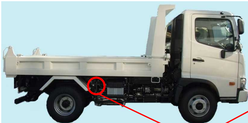
対向ブラケット（矢印2箇所が固定用ボルト）
