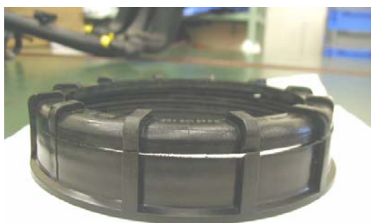
燃料ポンプ締付キャップの破損
