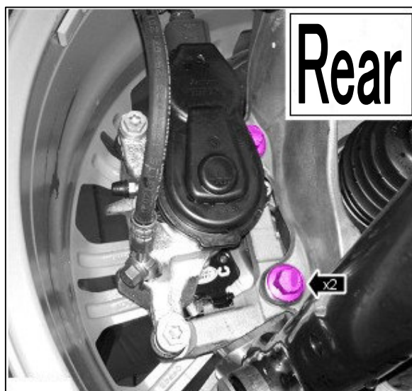
■ 不具合発生箇所（ブラケット固定ボルト片側 2 箇所）
