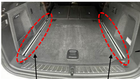
基準不適合発生箇所 固定レール
