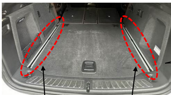
基準不適合発生箇所 固定レール
