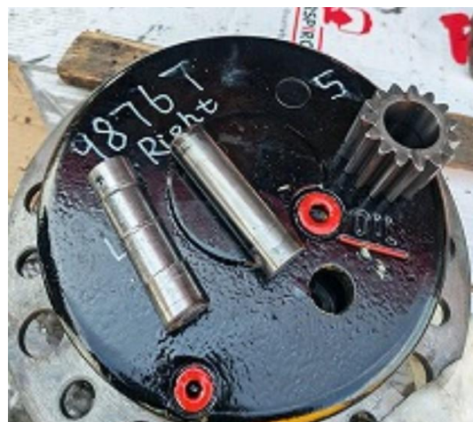
ハブリダクション機構分解図 赤丸: プラネタリギアピン
