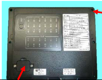
ラジコン受信機+制御ユニット
