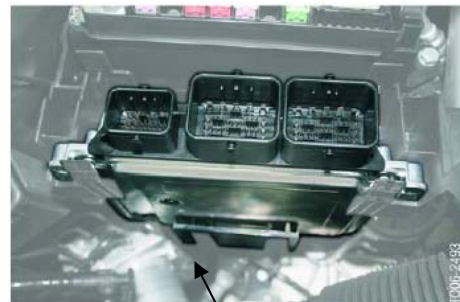
不具合発生箇所 エンジン コントロール ユニット (DME)
